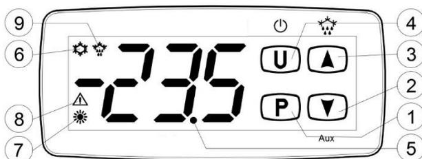
**1 - Tecla P:** Usada para configurar o SET POINT (pressione e solte) e para acessar os parâmetros de programação (mantenha pressionada por 5 segundos). No modo de programação é usada para entrar no modo de edição dos parâmetros e para confirmar os valores. No modo de programação pode ser usada junto com a tecla UP para alterar o nível de aceso dos parâmetros.
