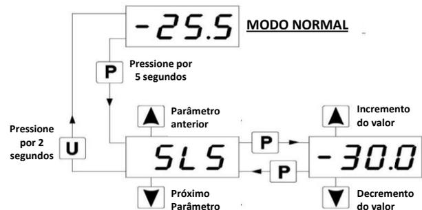
Para acessar os parâmetros de configuração do instrumento quando a proteção de senha está desativada, pressione a tecla P e mantenha-a pressionada durante 5 segundos, após isso o display apresentará o código que identifica o primeiro parâmetro e com as teclas UP ou DOWN selecione o parâmetro que será editado.
